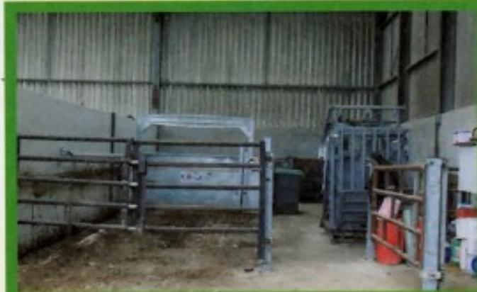
Florian Berthelémy a conçu lui-même sa contention l'an dernier sous un bâtiment. Une porte à double-sens permet de faire facilement avancer les animaux vers le couloir et la cage de pesée, et dans l'autre sens elle fait office pour le chargement en camion. *CS Bourgeois*
